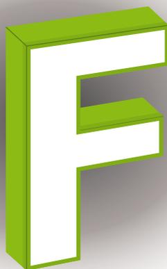
Il est possible de réaliser tous types de formes, tailles, polices et logos. Le fond et les chants sont en aluminium et la face est en méthacrylate diffusante fixée sur les chants par une cornière aluminium.
